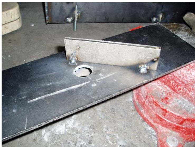
Kuva 19 Lämpömallin etulevyn taustapinnassa oleva savunohjain.
