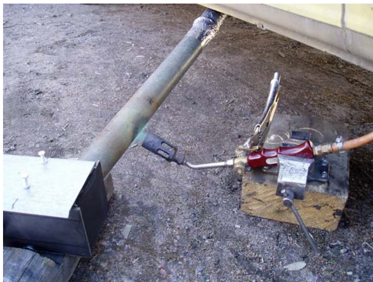
Kuva 21 Lämpömallin testauksessa lämpöä lisäksi nestekaasupolttimella.
