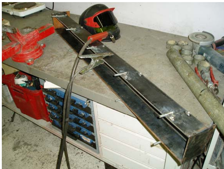
Kuva 16 Lämpömalliin hitsattuna etulevyn kiinnitysjenkatapit sekä pintapellin mutterit.
