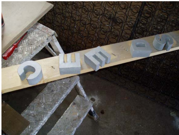
Kuva 51 Uretaanilevystä sahatut ja maalatut kirjaimet hahmomalliin.
