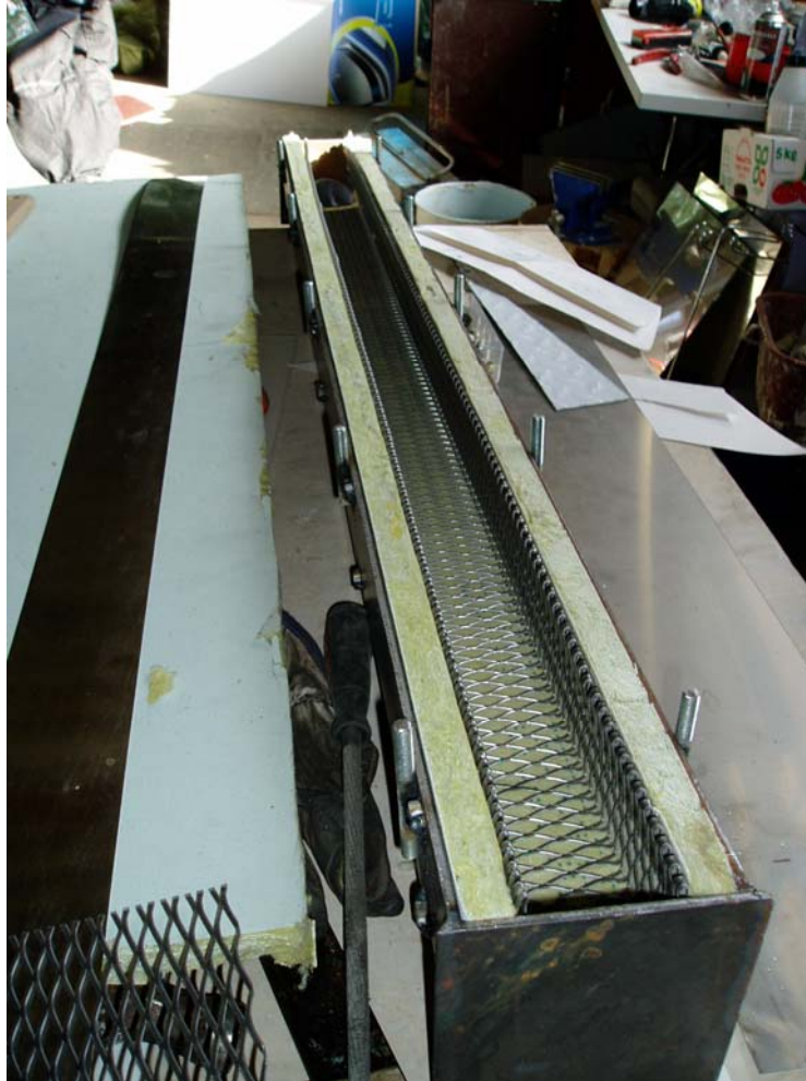
Kuva 20 Lämpötestausmallin palovillaeriste ja tukiverkko.
