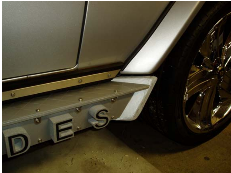
Kuva 57 Astinlautapakoputkessa ei saa olla teräviä ulokkeita.
