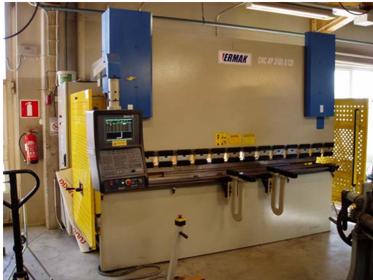
Kuva 14 Lämpömallin 90 asteen kulmat kantattiin särmäyskoneella.
