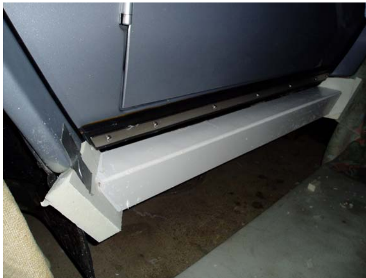
Kuva 49 Hahmomallin raakaversion sovitusta ja mitoitusta autoon.
