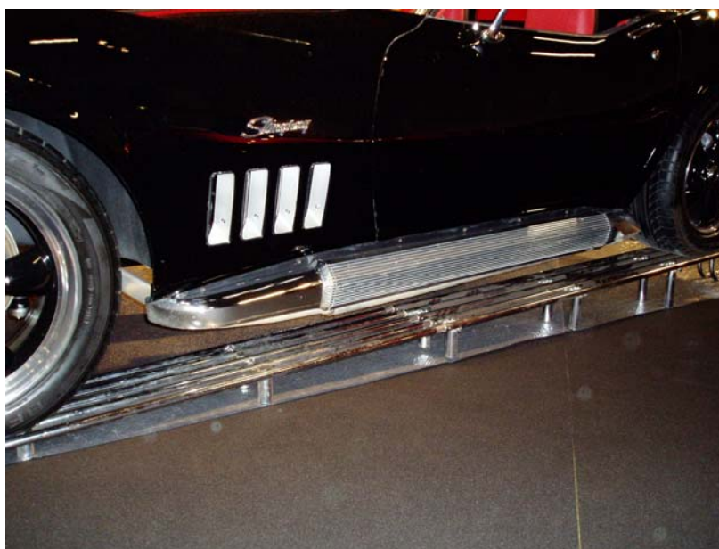
Kuva 9 Urheilumallisen näyttelyauton pakoputken ulostulo. Ovenalus on lämpösuojattu.
