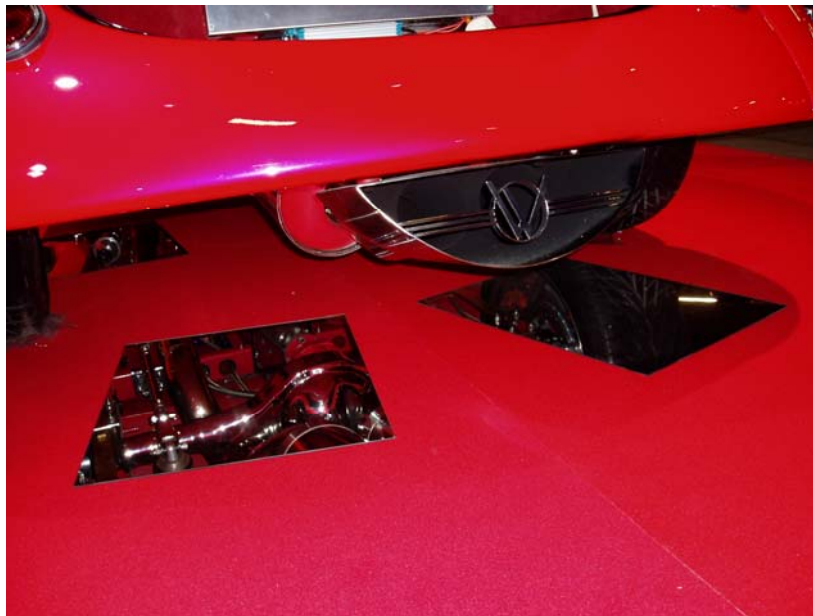
Kuva 7 Messuilla olleen näyttelyauton itse rakennettu pakoputkenpää.
