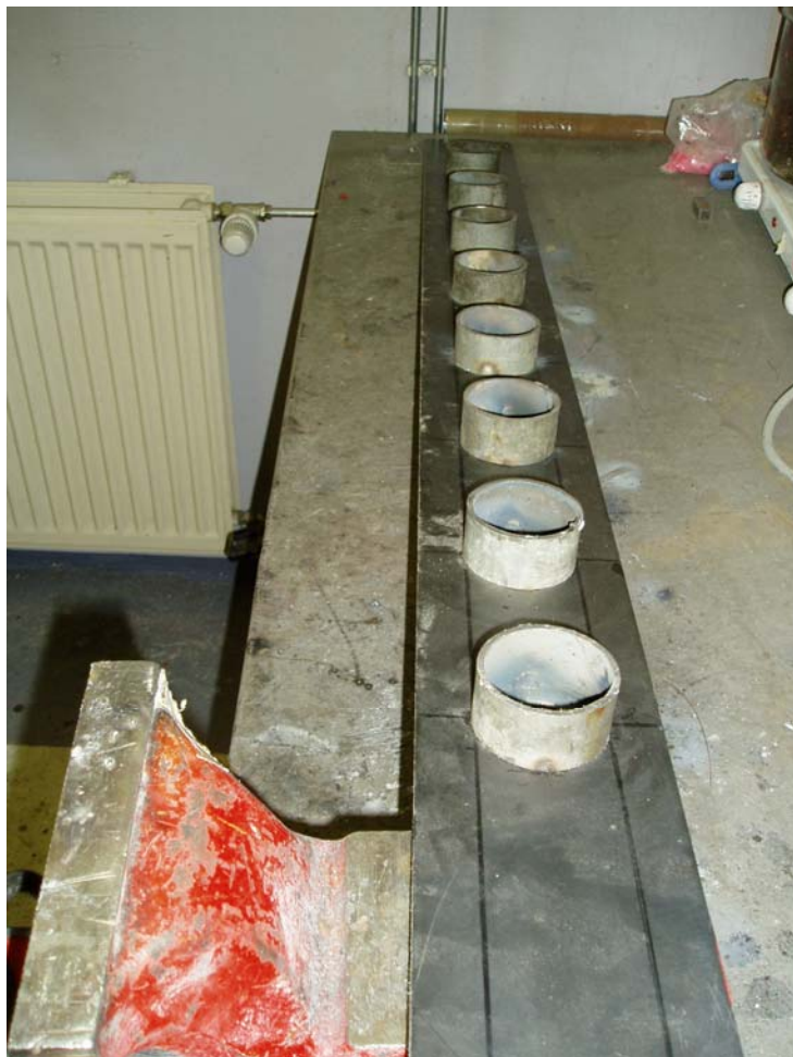
Kuva 18 Lämpömallin etulevyn hitsattuna pakoputkenpäät.
