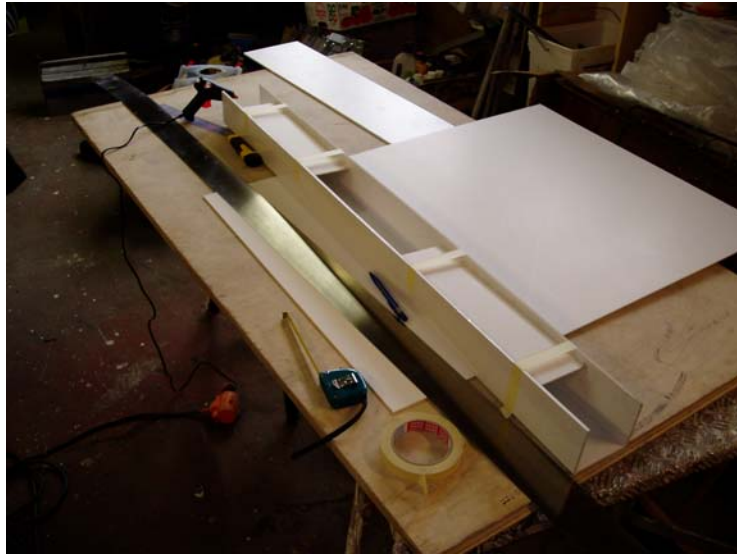
Kuva 47 Astinlautapakoputken hahmomallin runko.
