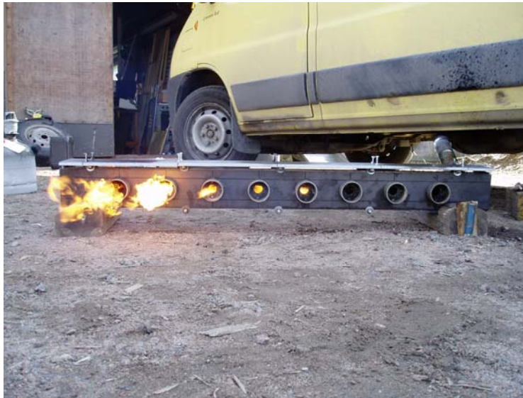
Kuva 38 Pakokaasunpaine siirtää liekit palamaan loppupään pakoputkenpäistä.
