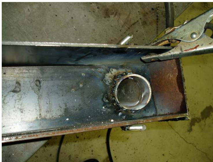
Kuva 17 Lämpömalliin hitsattuna savun ja lämmön johdatusputki sekä päätykappaleet.
