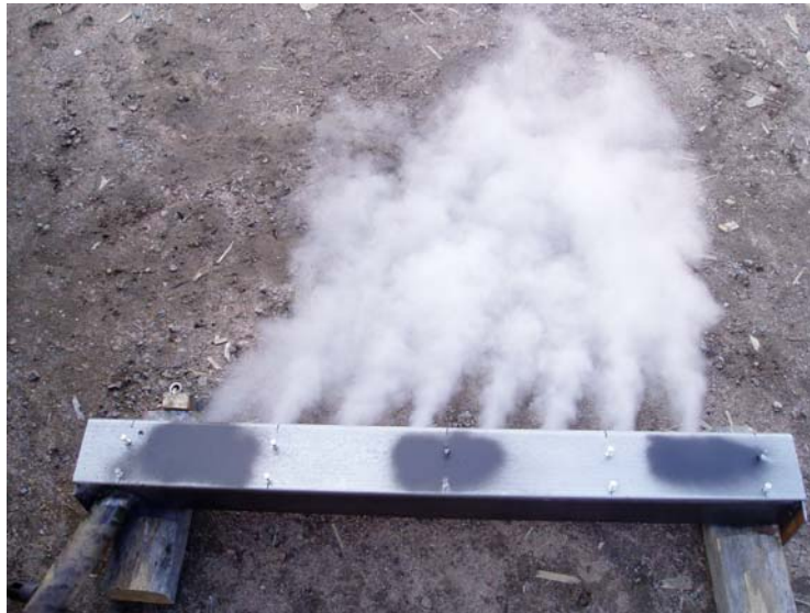
Kuva 36 Savunjohtimesta ruiskutettu polttoöljy sai aikaan näyttävän savun.
