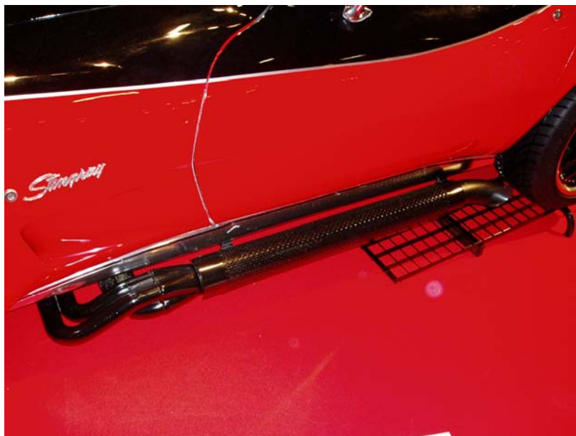
Kuva 8 Urheilumallisen näyttelyauton pakoputken ulostulo. Ovenalus on lämpösuojattu.
