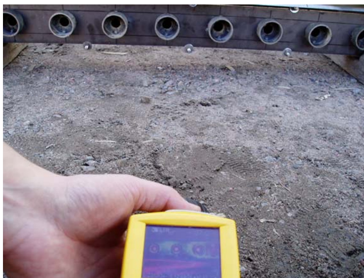
Kuva 25 Lämpökamera vastaanottaa lämpösäteilyä ja muuttaa sen digitaalseksi kuvaksi.
