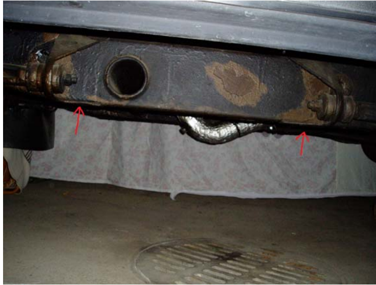
Kuva 61 Astinlautapakoputket kiinnitetään auton runkoputkenkorvakkeisiin u-profilisilla kiskoilla.
