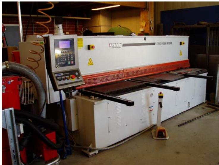
Kuva 13 Lämpömalliin tulevat metallikappaleet leikattiin hydraulisesti.
