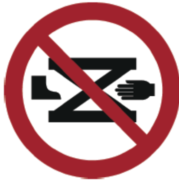
Kuva F.1 Varoitusmerkintä - Älä laita käsiä tai jalkoja nostotason alle (ks. kohta 7.2.4)
