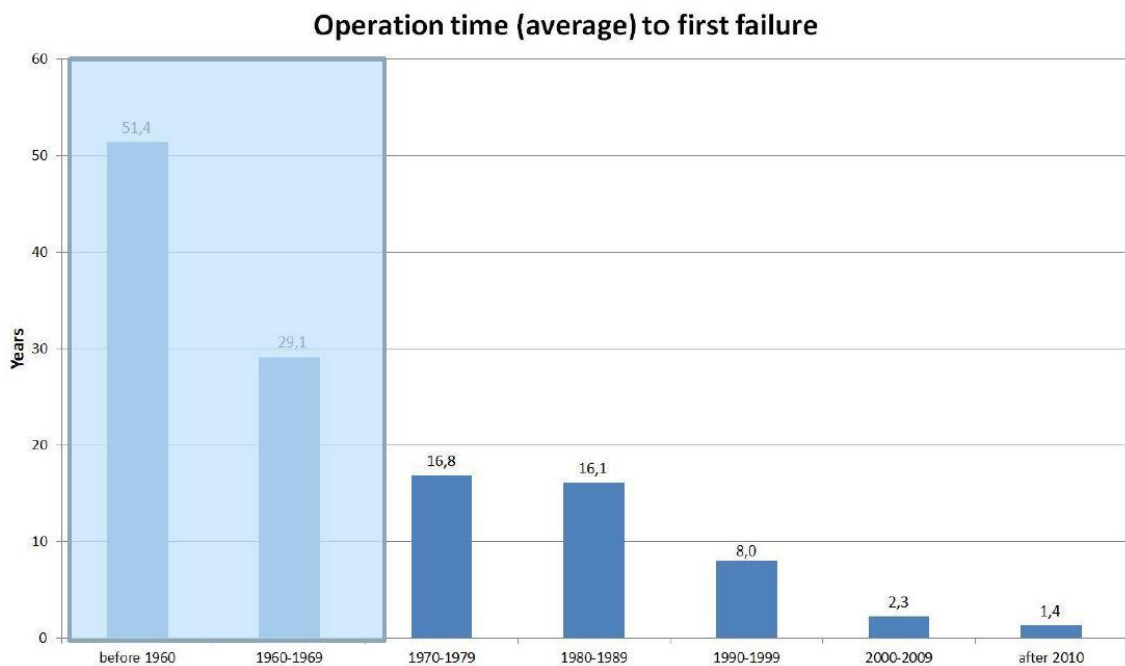
KUVA 15. Generaattoreiden keskimääräinen käyttöaika ennen ensimmäistä vikaantumista valmistusvuoden perusteella (12, s. 67)
