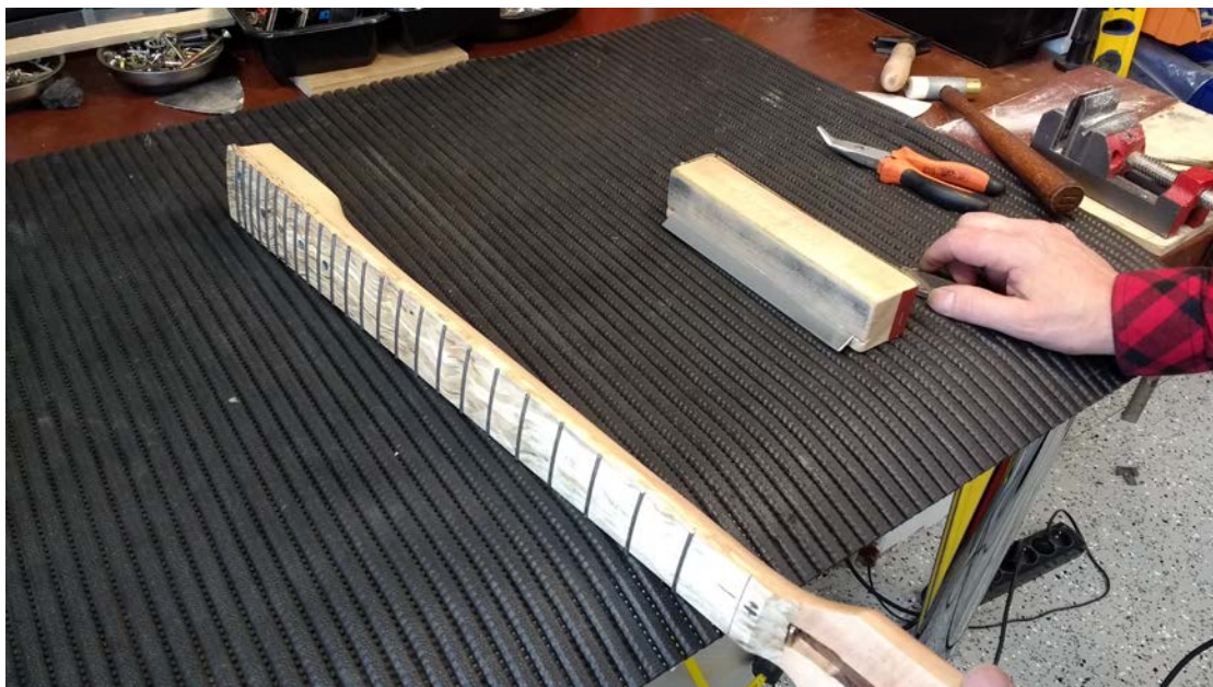
Kuva 19. Nauhojen päiden hiominen 45 asteen kulmaan (Vainikka 2017)
