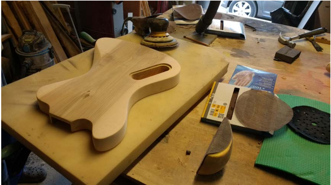
Kuva 21. Bodyn hiominen epäkeskohiomakoneella (Vainikka 2017)
