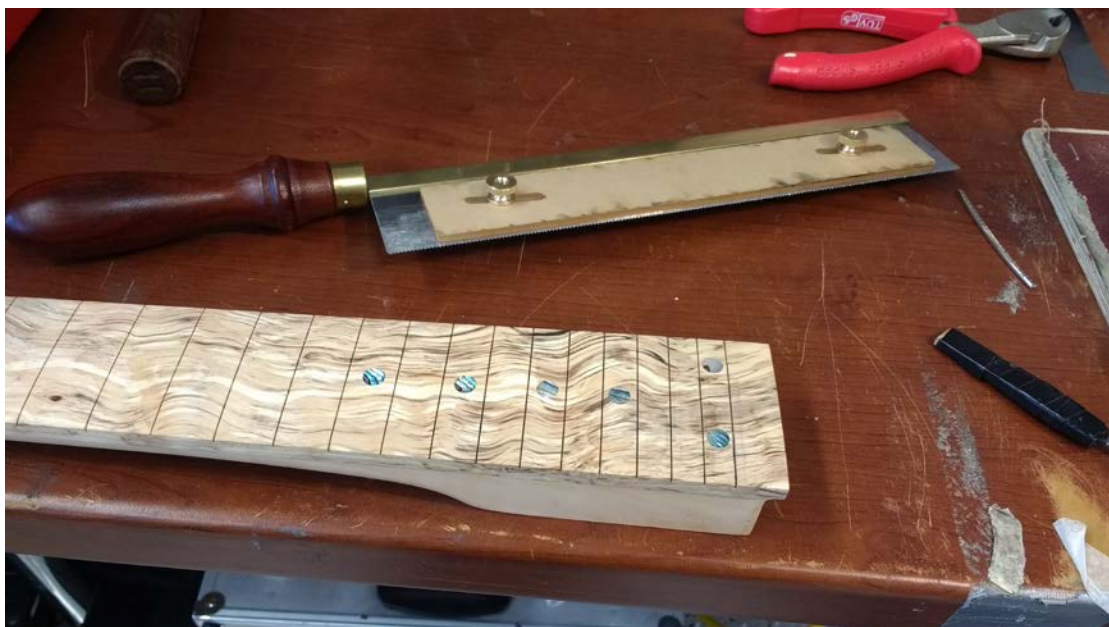
Kuva 17. Nauhaurien syventäminen, yläpuolella japanin saha (Vainikka 2017)
