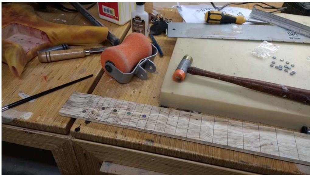
Kuva 12. Otelautamerkkien liimaaminen (Vainikka 2017)
