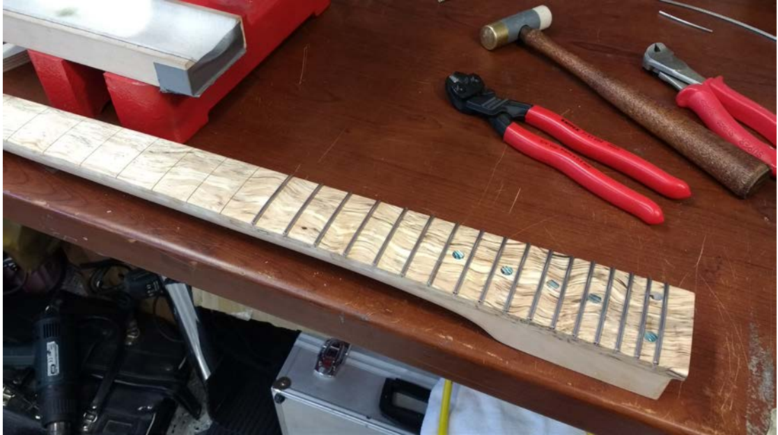
Kuva 18. Kaulan nauhoittaminen (Vainikka 2017)
