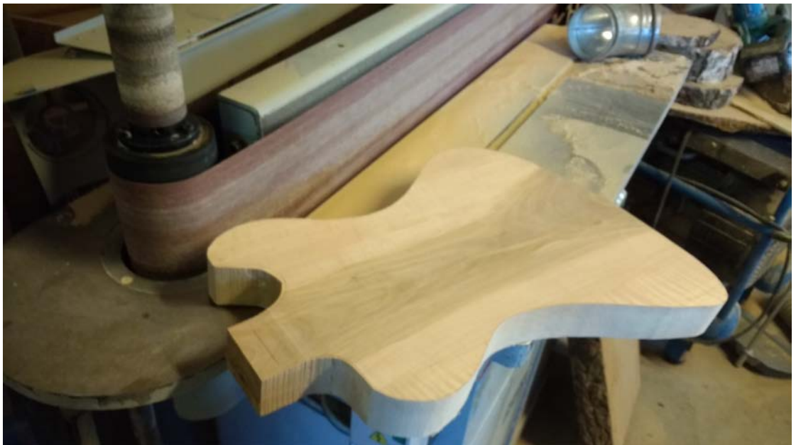
Kuva 9. Bodyn muodon hakemista nauhahiomakoneella (Vainikka 2017)
