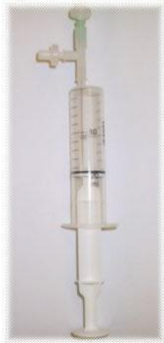
Kuva 2. Finnoflag Oy:n kehittämä näyteruisku, jota käytetään PMEU-laitteessa rikastuksessa.
