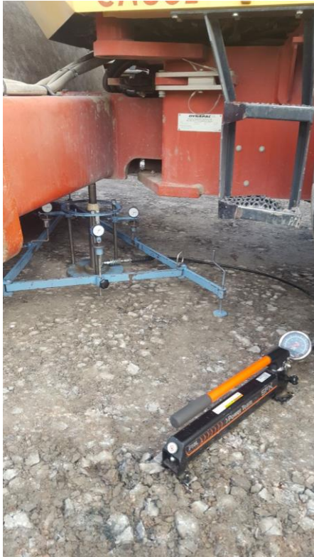
Kuva 4. Levykuormituskokeen otto, vastapainona jyrä.
