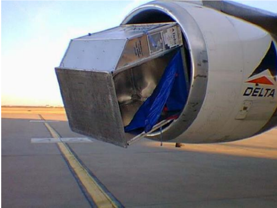
Kuva 19. Matkatavarakontti imeytynyt lentokoneen moottoriin. [2.]
