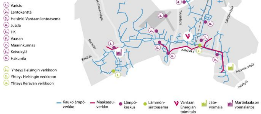
Kuva 2. Vantaan kaukolämpöverkko, tuotantolaitokset, sekä siirtoasemat [5].
