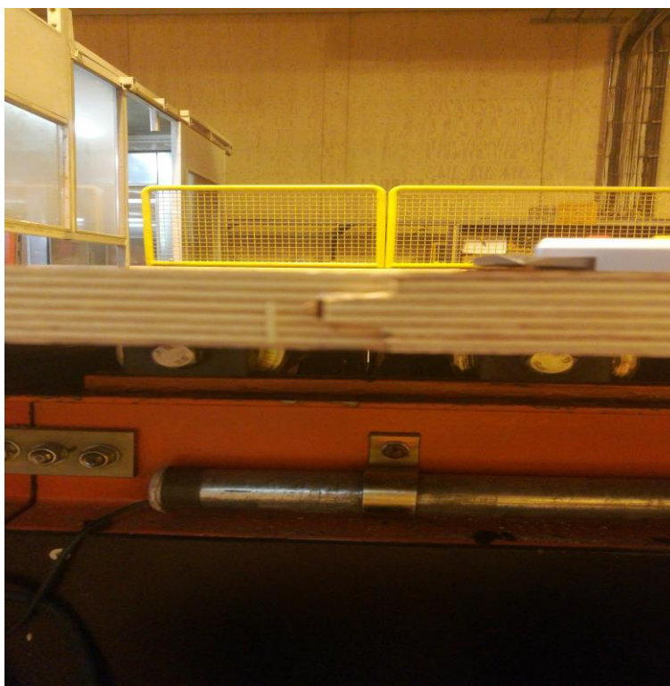
KUVA 10. Homag-reunasahalla pontin sovittamista.
