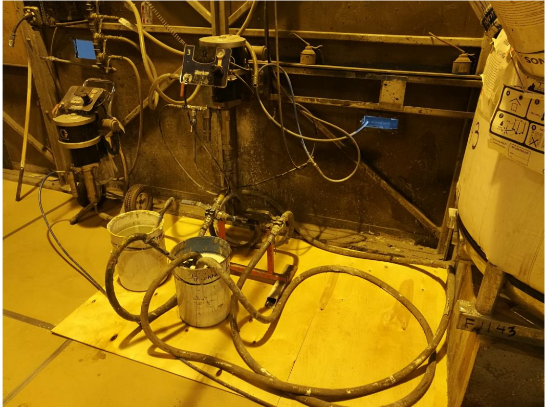
KUVA 4. Merkur-korkeapainepumpun siirrettävä versio sekä seinäkiinnitys Koskisen Oy:llä.
