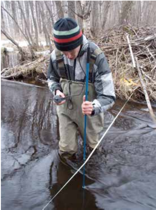
Kuva 10. Karelia-ammattikorkeakoulun insinööriopiskelija Santeri Rautio mittaa virtaamaa Flowwatch™ -siivikon avulla Kuonanjoen havaintopaikalla 030 huhtikuussa 2017.
