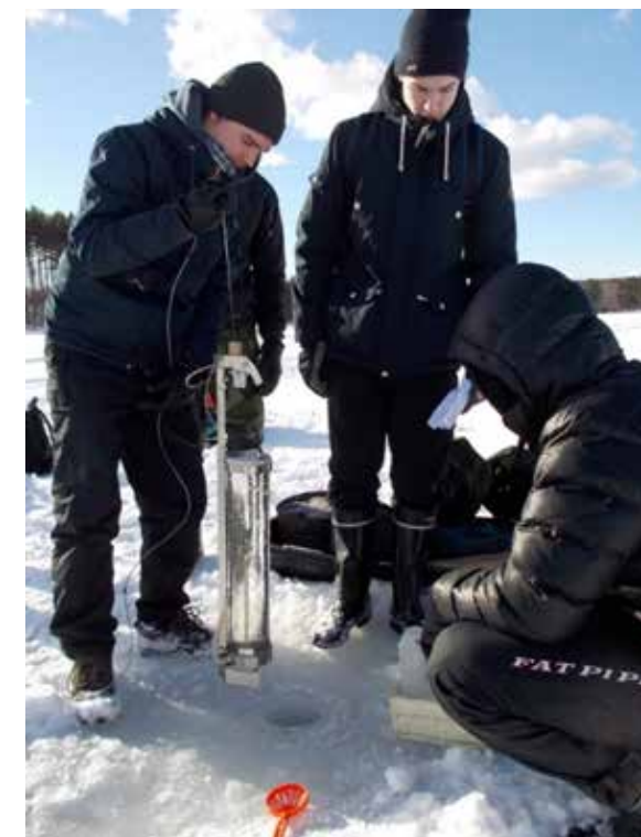
Kuva 8. Karelia-ammattikorkeakoulun insinööriopiskelijat (vas. luki- en) Otto Schmidt, Mikael Raineva ja Tuomas Tokola ottavat Limnos- näytteenottimella vesinäytettä Puruveden Savonlahdella maaliskuun lopulla 2017.
