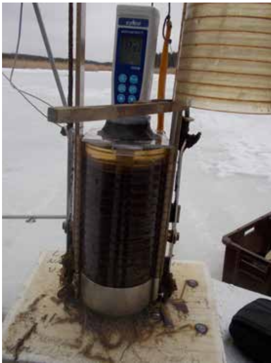
Kuva 14. Limnos-sedimenttinoutimella otettu Puruveden edustan ulappa-alueen sedimentinäyte ja Karelia-ammattikorkeakoulun opiskelija Santeri Rautio huhtikuussa 2017.
