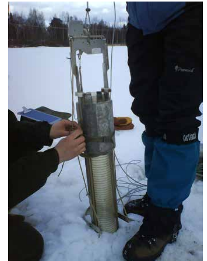
Kuva 13. Lyijypainoja kiinnitetään Limnos-sedimenttinoutimeen näytteenottoa varten.
