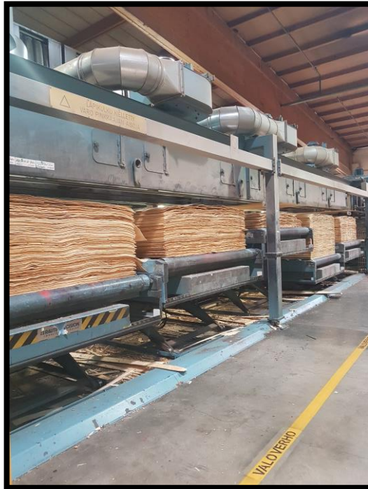
KUVA 2. Viilut kuivauksen jälkeen lajiteltuina lujuus/laatuluokkiin. (Leskinen 2017)
