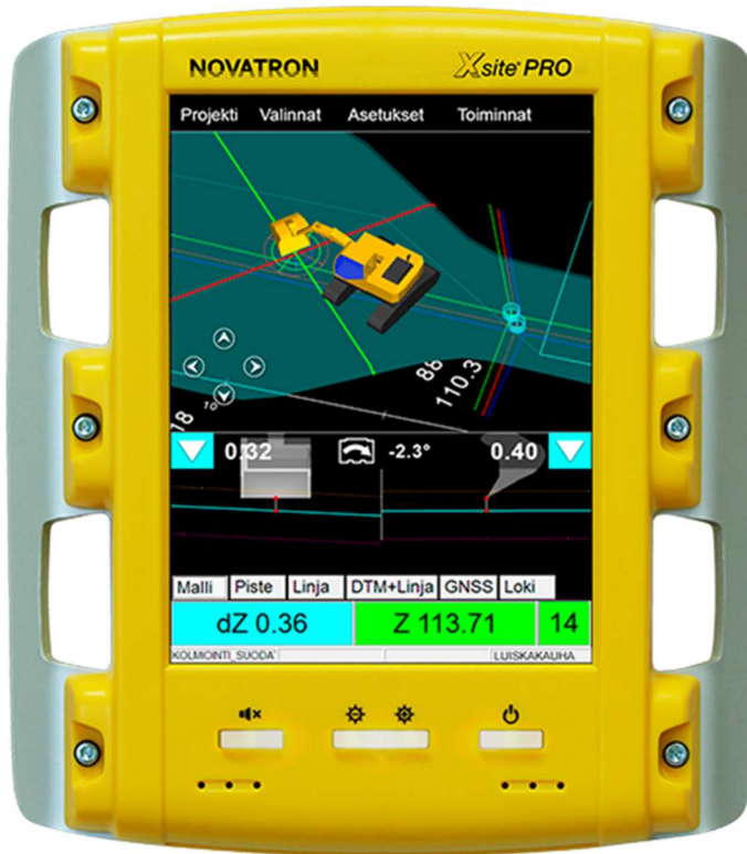
Kuvio 4. Työkoneen kuljettaja näkee kolmiulotteiset toteutusmallit ja kauhan sijainnin koneohjausjärjestelmän näytöltä. Kuva Novatronin Xsite Pro 3D-näyttöpäätteestä (Novatron 2018b)
