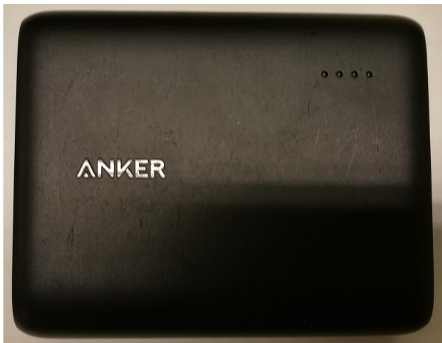
Kuva 7. Projektin alkuvaiheessa käytetyt Ankerin 10 400 mAh:n varavirtalähteet
