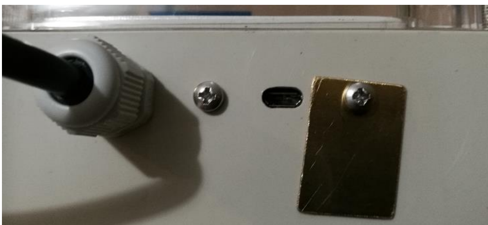
Kuva 29. Latausportti ja sen suoja Levy
