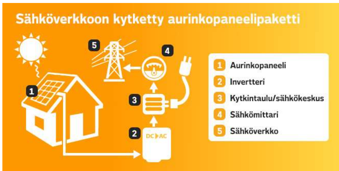
Kuvio 9. Verkkoon kytketyn aurinkopaneelijärjestelmän toimintaperiaate. (Vattenfall Oy, [viitattu 7.2.2018]).
