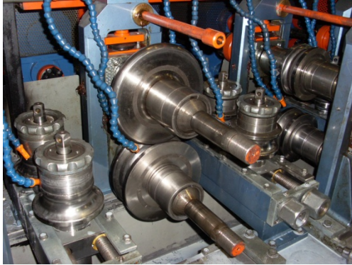
Kuva 13. Holkkien ja rullien poistaminen
