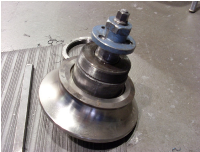
Kuva 22. Hitsausrullien edessä olevien rullien keskiön irrotus
