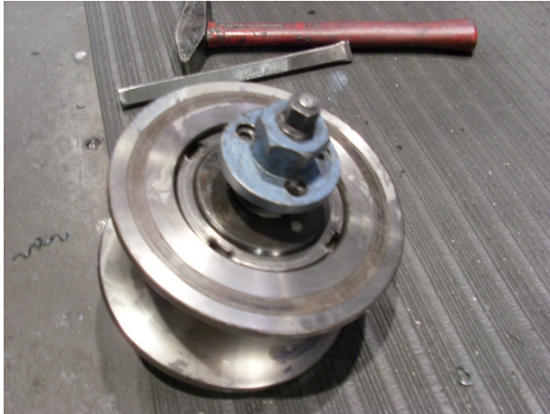
Kuva 16. Hitsausrullien edessä oleva työkalurulla ja irrotettava keskiö
