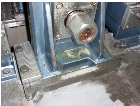
Kuva 12. Pultit, joilla pukki on kiinni
