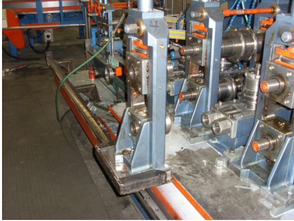
Kuva 27. Liukuva teline, johon pukit saa vedettyä
