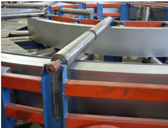
Kuva 20. Akkumuloivan varaston rullien säätäminen
