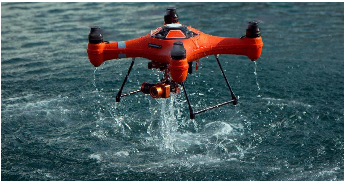
Kuva 14. SwellPro Splash Drone 3 Auto on miehittämätön ilma-alus, joka kestää jopa hetkeksen upotuksen veteen (IP67). Se maksaa noin 1 750 euroa. [28.]
