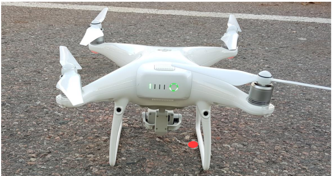
Kuva 12. Kotiinpaluutoiminto on hyvissä olosuhteissa yllättävän tarkka. Tässä tapauksessa Phantom 4 Pro osasi palata muutamien senttimetrien päähän lähtöpisteestä. Eli punaisen pisteen osoittama kohta oli noustessa kameran kohdalla, keskellä ilma-alusta ja laitteen laskeutuessa laskeutumistelineen kohdalla.
