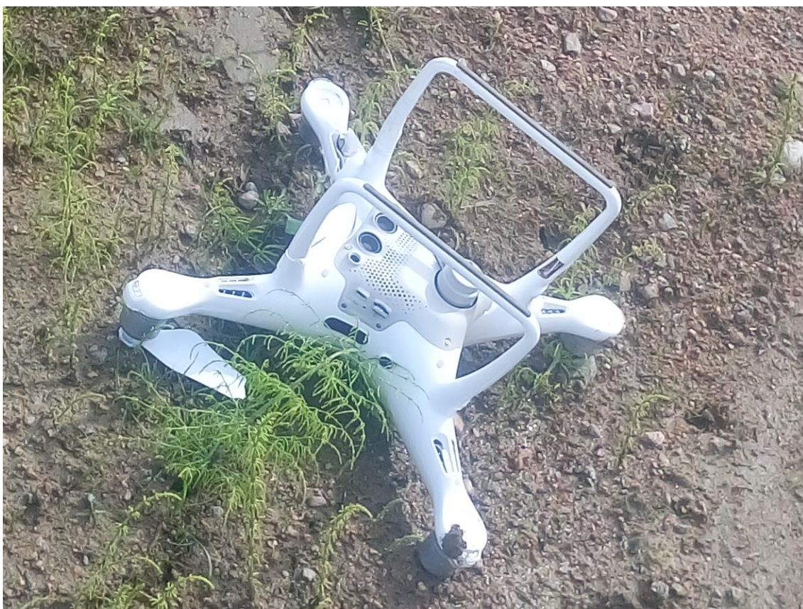
Kuva 6. Phantom 4 Pro putosi lentäessä liian lähelle voimavirtajohtoja. Ilmeisesti ilma-aluksen GPS meni sekaisin, vaikka matkaa linjoihin oli vielä reippaasti. Sen seurauksena se putosi maahan ja hajosi käyttökelttomaksi. [23.]
