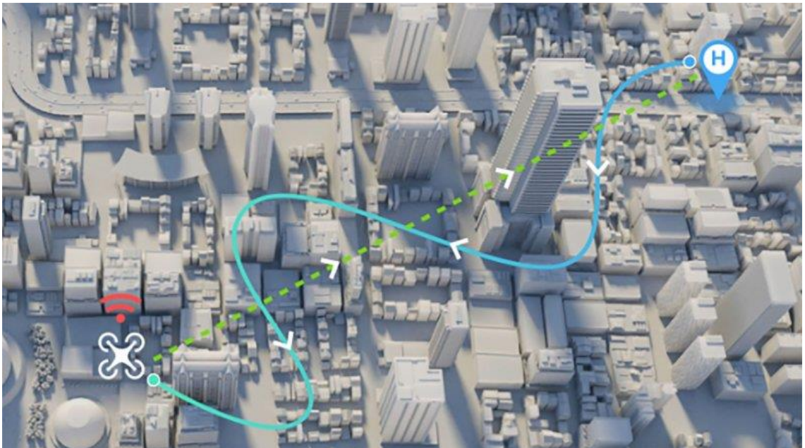
Kuva 11. Kotiinpaluutoiminnon havainnekuva. Sininen viiva kuvaa lennätettyä reittiä ja vihreä viiva kotiinpaluutoiminnon aktivoiduttua laitteen lentämää reittiä takaisin. [27.]
