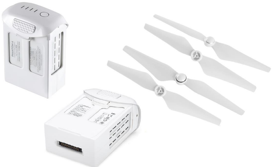
Kuva 7. DJI Phantom 4:sen "Intelligent Flight Battery" -tehoakku ja roottorit [32].
