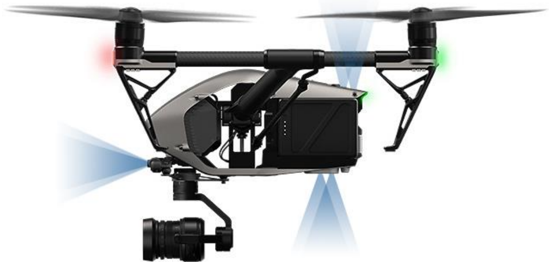
Kuva 13. Eteen- ja alaspäin suunnattujen sensoreiden avulla Inspire 2 havaitsee esteitä jopa 30 metrin päähän mahdollistaen turvallisen lennättämisen jopa 54 km/h nopeudessa. Ylöspäin suunnatut infrapunatunnistimet skannaavat esteitä 5 metrin päähän lisäämällä suojaa lennätettäessä suljetuissa tiloissa. [32.]
