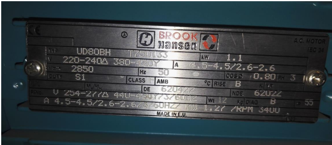
Kuva 5. Käytetyn vaihtosähkömoottorin tyyppikilpi.
