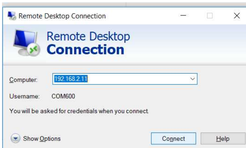
KUVA 26. Etäyhteyden muodostaminen COM600-yksikköön
