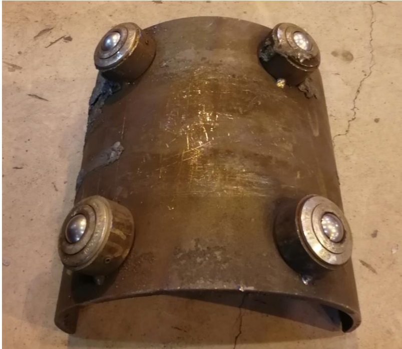
Kuva 17. Nykyinen putkisuoja (Hansen.J, 2017)
