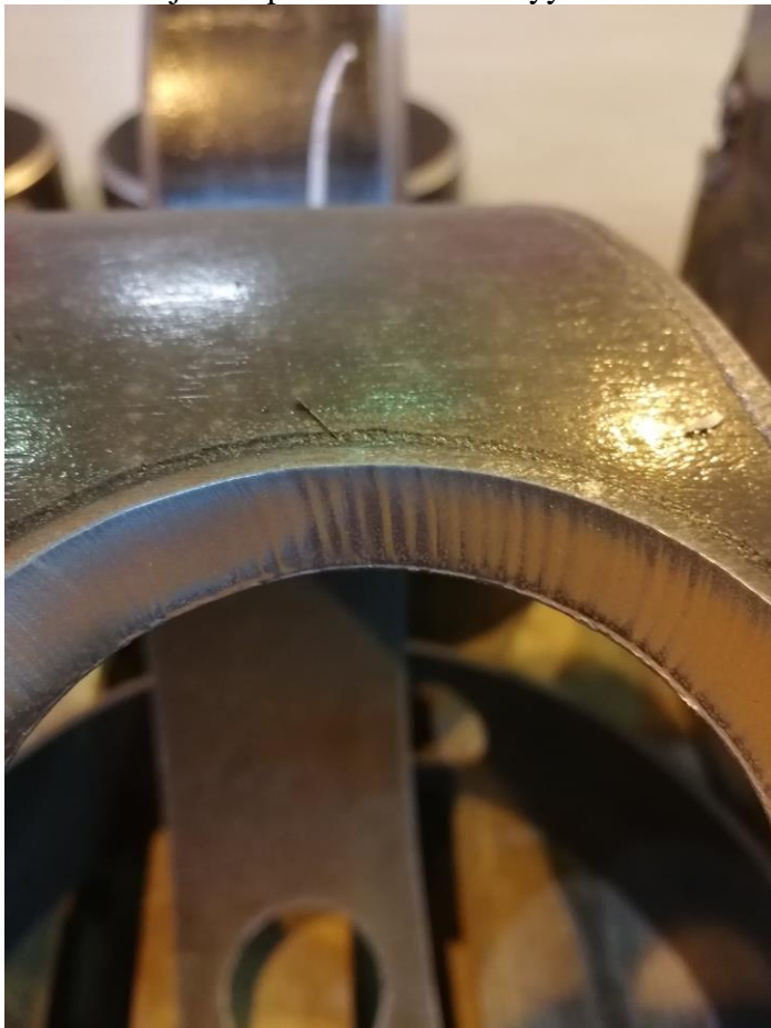
Kuva 20. Leikkuujälki paineilmalla leikattaessa (Hansen J, 2017)
