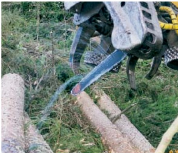
Kuva 4. Kantokäsittelylaite toiminnassa (Metsäteho Oy 2017)
