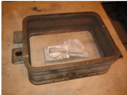
Kuva 11. Irtomallikaavauksen ensimmäinen vaihe (Keskinen & Niemi 2007)
