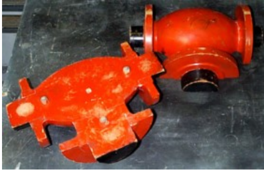
Kuva 10. Erään venttiilin rungon jaettu keernakannallinen valumalli (Soininen 2018)
