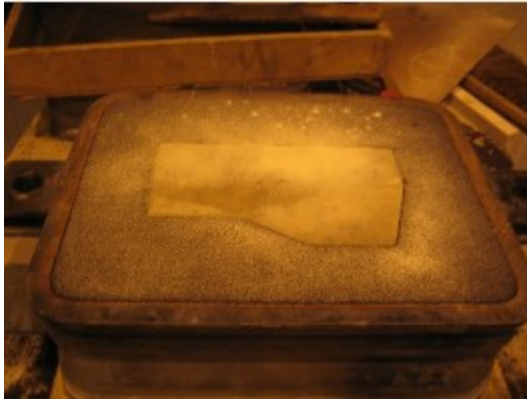
Kuva 13. Muotin puolikas käännetty (Keskinen & Niemi 2007)
