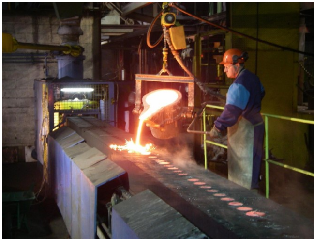
Kuva 16. Manuaalinen valu valmiisiin pullamuotteihin (Caffier Barreau Industries 2018)
