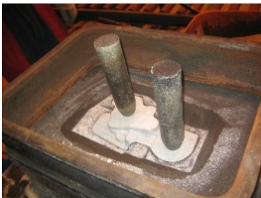
Kuva 14. Hiekkamuotti ennen yläkehän sullontaa (Keskinen & Niemi 2007)
