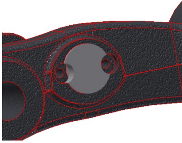
Kuva 23. Sylinterin kiinnitystappi mallissa paikoillaan ilman lukitusruuveja
