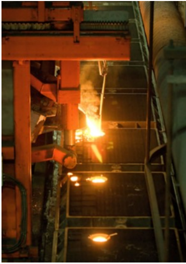
Kuva 7. Koneellinen valuprosessi konekaavauslinjastolla (Componenta Oyj 2018a)
