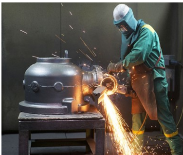
Kuva 8. Valukkeen irrotus (AHC 2018)
