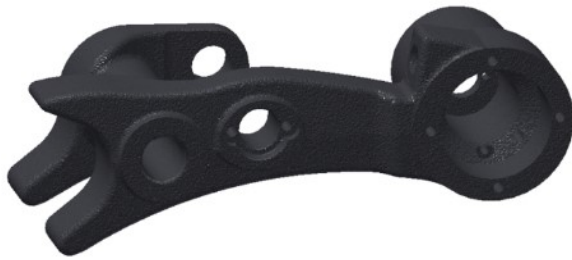
Kuva 24. Toinen versio koneistuspiirteillä
