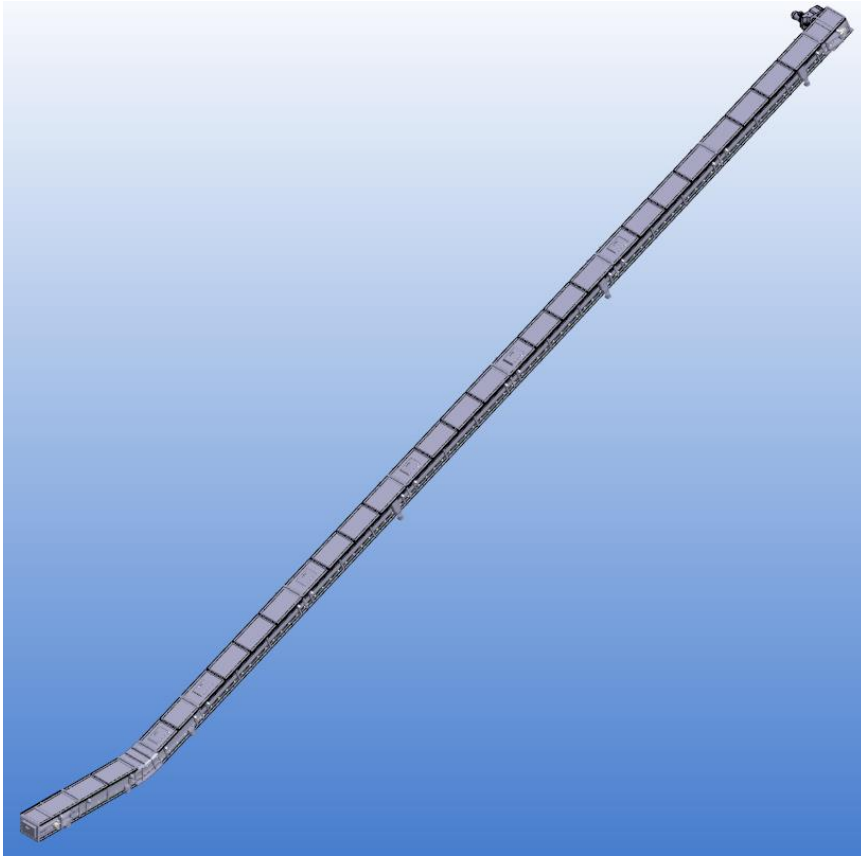
Kuvio 7. Kolakuljetin, jonka pohjalta lähdettiin rakentamaan malleja suunnitteluautomaattia varten.
