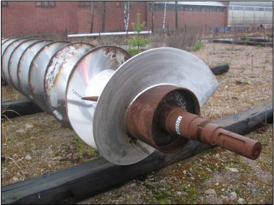
Kuva 4.5 Huonosti suojattu akselinpää ulkovarastossa.
