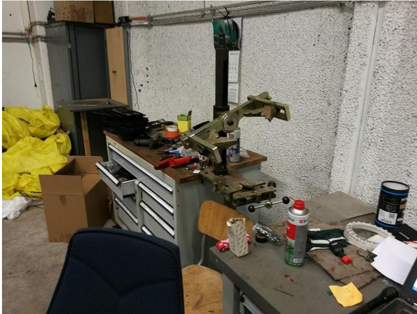
Kuva 2. Työpisteellä sijaitseva iskunvaimentajan jousen irrotustyökalu
