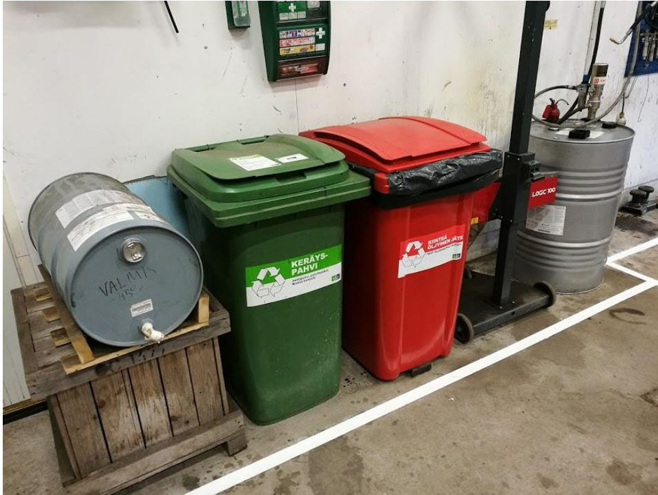
Kuva 8. Pahvi- ja kiinteä öljyjäteastiat sekä valojensuuntaus ja nesteet omilla paikoillaan
