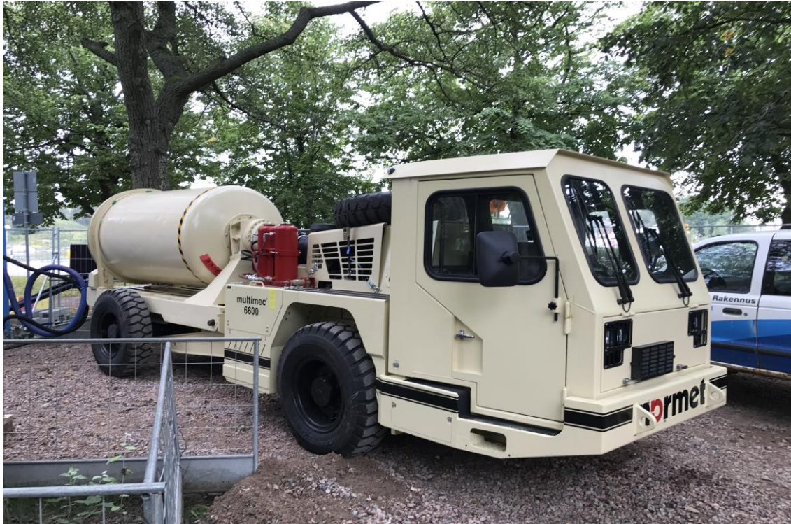
Kuva 22. Normetin betonin kuljetusauto. [Rinkinen, 2017, YIT]
