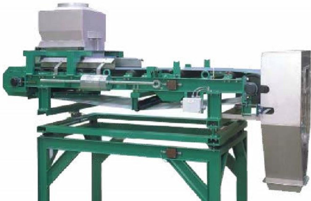
Kuva 2. Aiemmin laitteen runko on kokoonpantu profiiliteräksistä (Lahti Precision. 2014)
