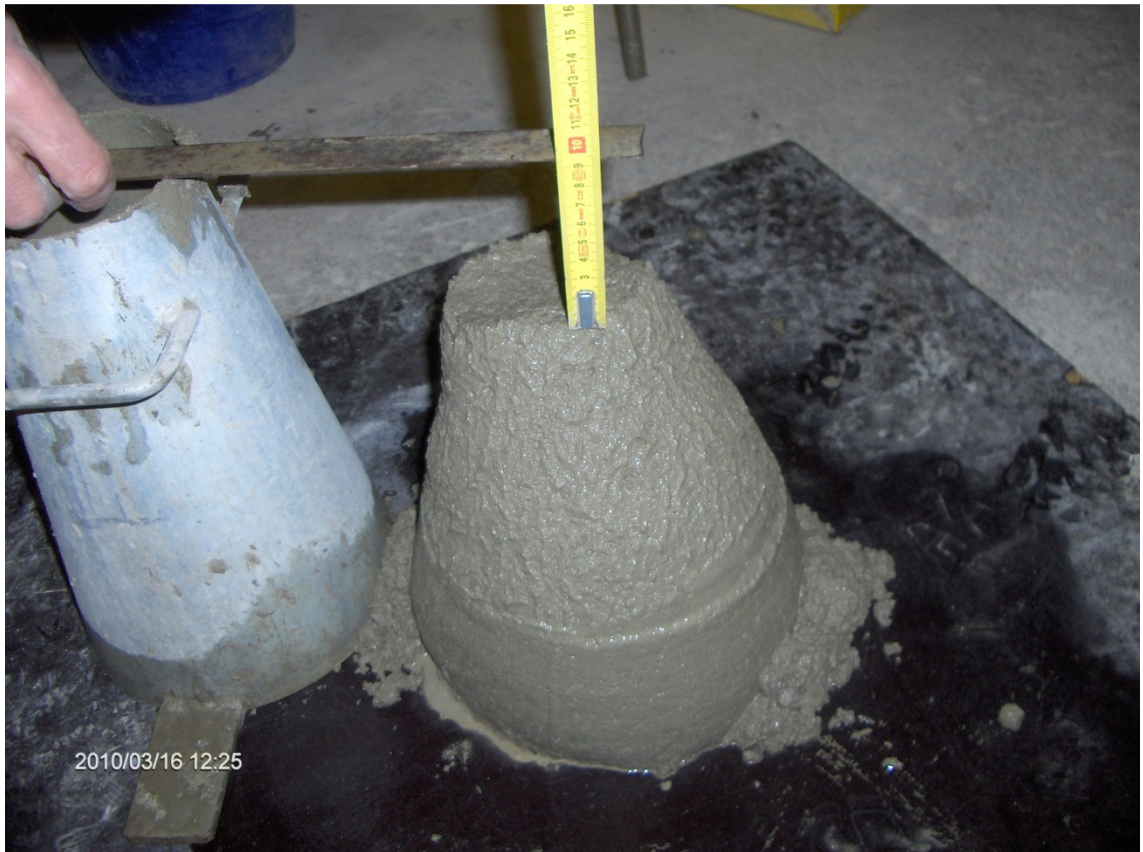
Kuva 2. Säänkestävän kupuhierron painuman mittaus tunnin kuluttua massan valmistumisesta
