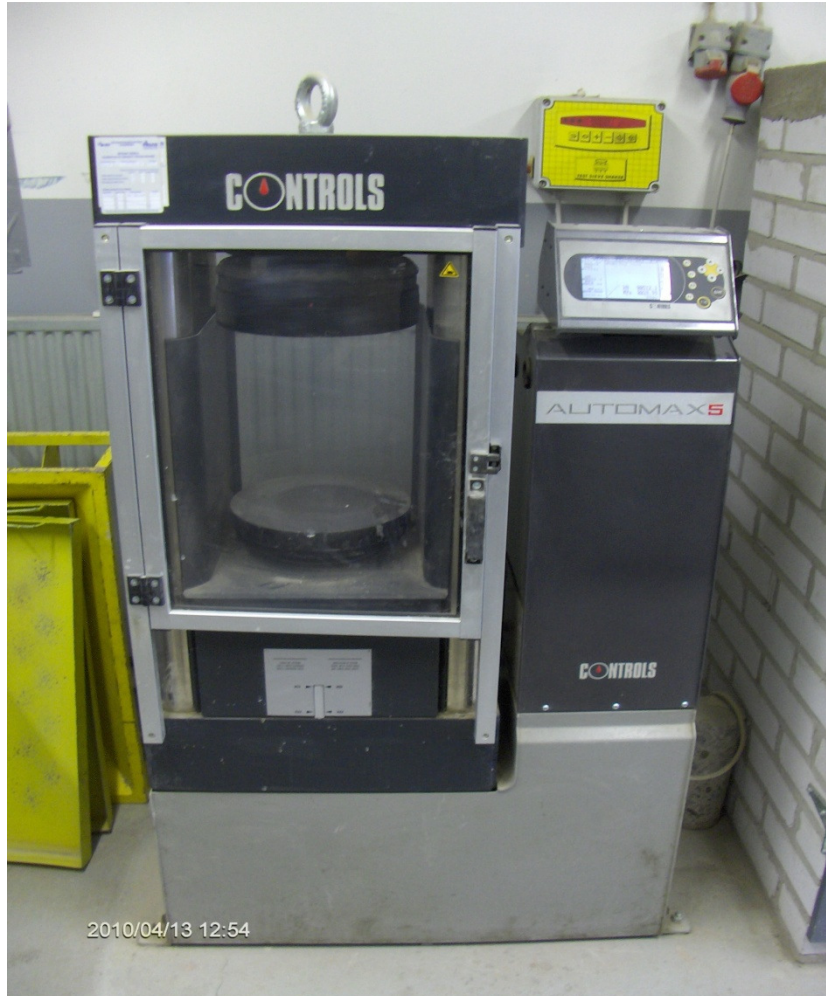
Kuva 5. Koekappalepuristin, Controls AUTOMAX5
