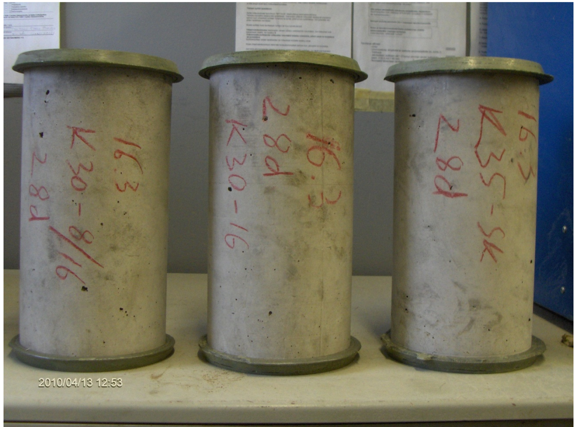
Kuva 4. Koekappaleet joiden päät ovat rikitetty
