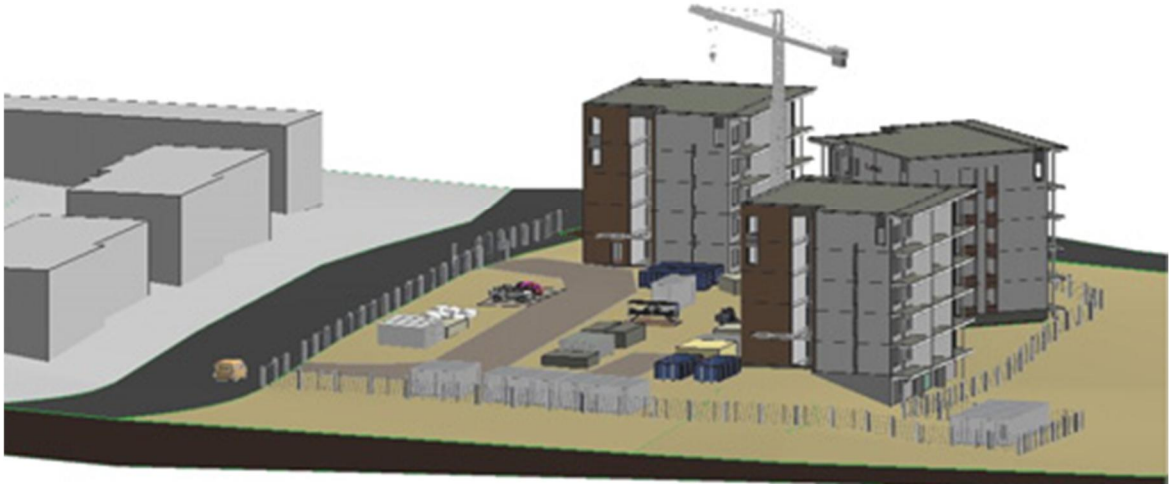
Kuva 3 Tietomallin pohjalta tehty työmaan aluesuunnitelma [18, kansilehti]
