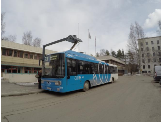
Kuva 5. Sähkölinja-auto latauksessa Ruskeasuolla
