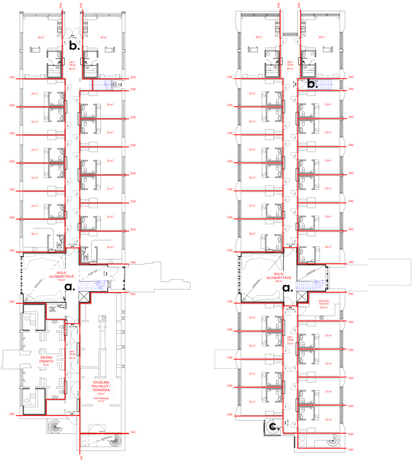
Kuva 24. Palo-osastointi ja poistumistiet
