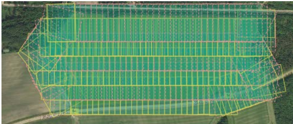
Kuva 4. Kolmesataa ylhäältäpäin otettua kuvaa muodostaa yhden ortoilmakuvan. Yksittäinen ruutu on yksi valokuva. (Rekola, 2018)
