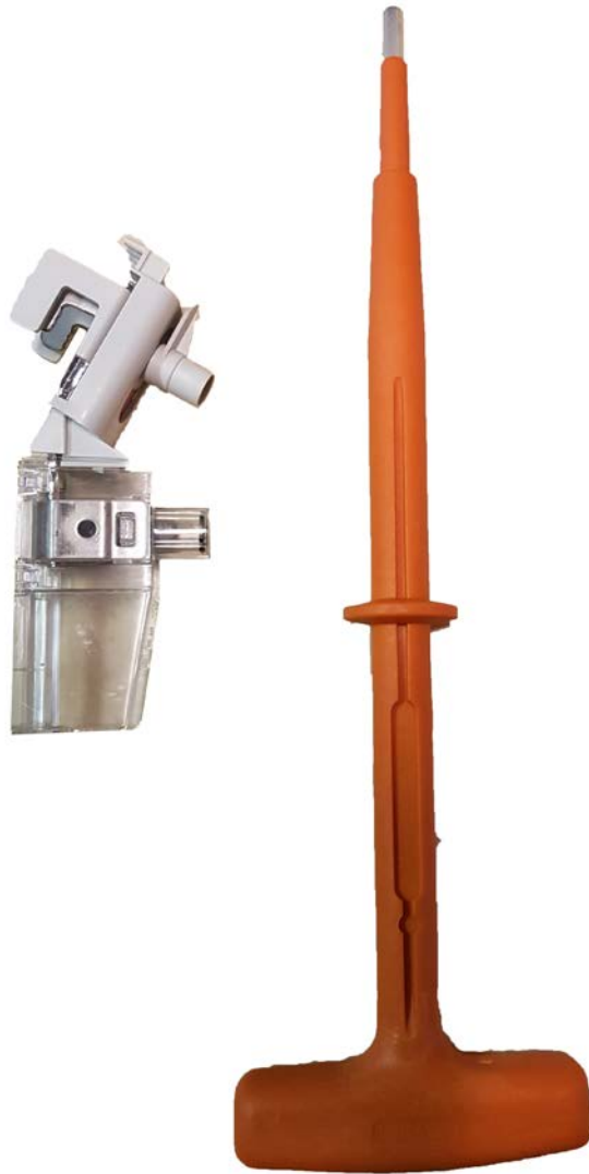
KUVA 4-16. 5mm kuusiokolojännitetyökalu ja kytkinliitin kaapelijakokaappiin. (Timo Juntunen 2018)
