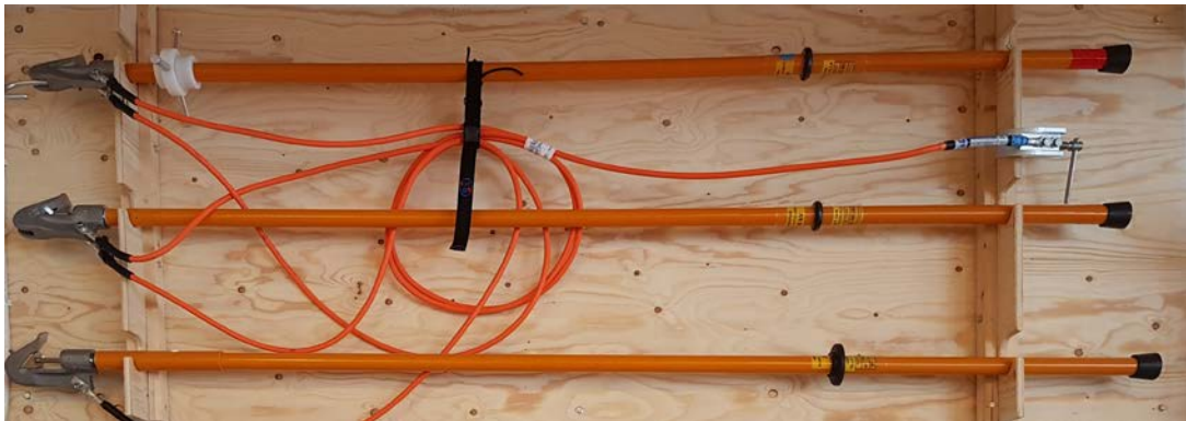
KUVA 4-1. Työmaadoitusvälineet (Timo Juntunen 2018)
