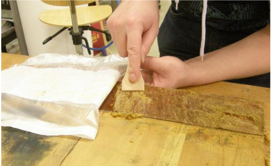
Kuva 24. Sellakan poisto (Huovila 2018)
