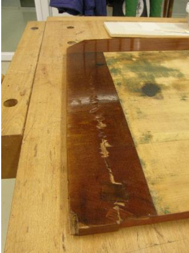
Kuva 20. Kannen haljennut viilu (Roivas 2018)
