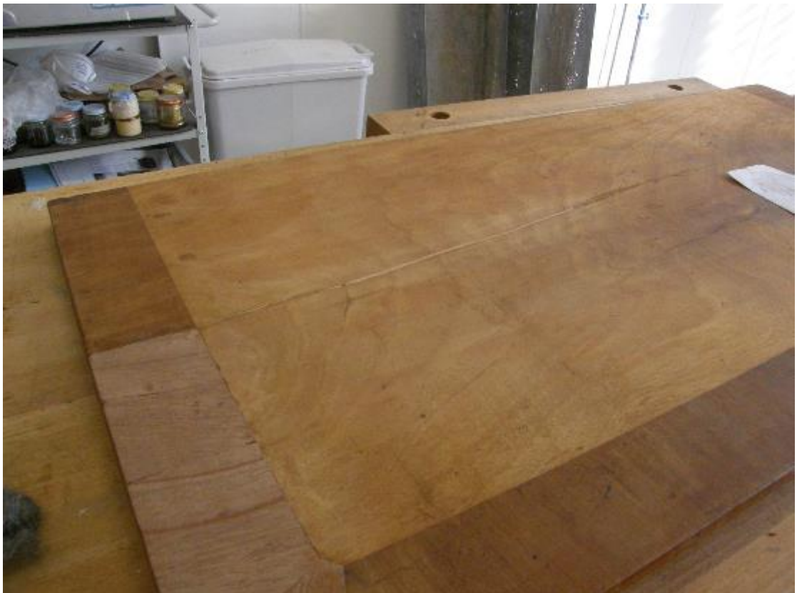
Kannen halkeama korjattuna (Roivas 2018)
