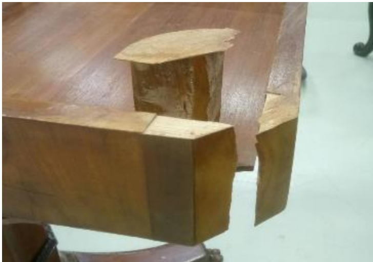
Kuva 21. Irronnut kulmaklossi (Roivas 2018)
