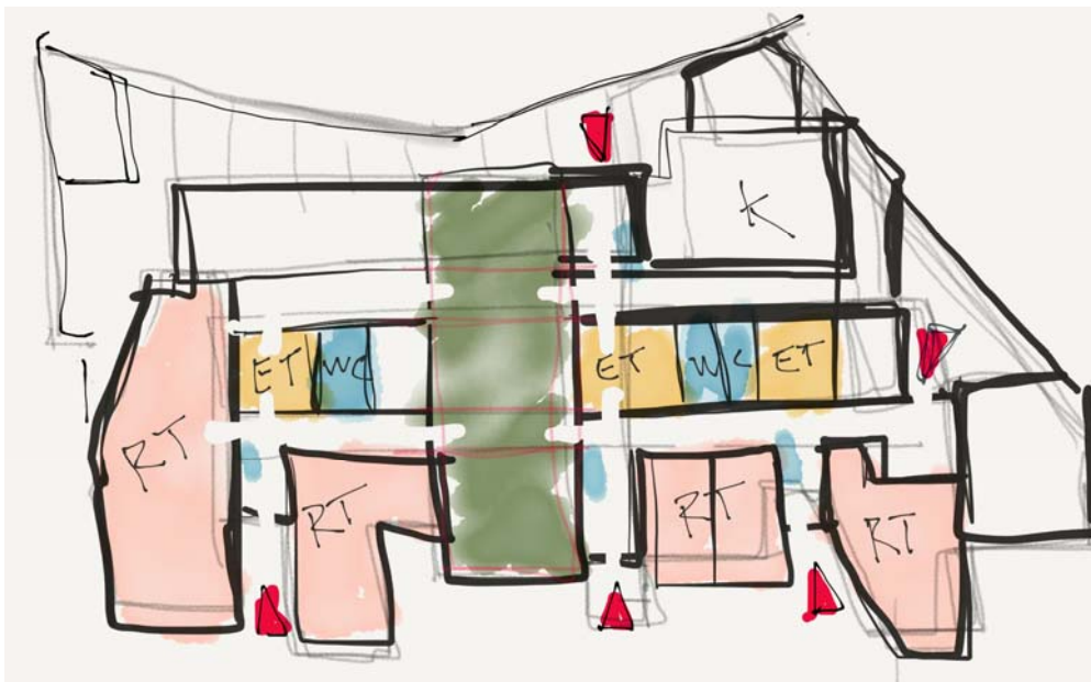
Kuva 19. Kaavio rakennuksen ensimmäisestä kerroksesta. Tilat sijoittuvat tehokkaasti käytävien varrelle. Rakennuksen sydämenä on suuri jaettava salitila (vihreällä).
