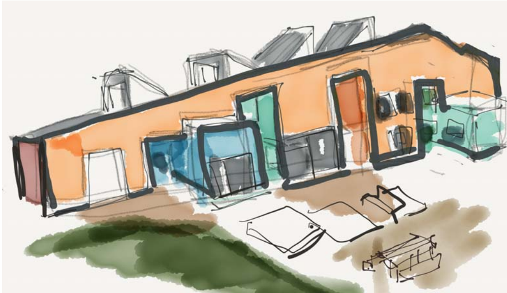
Kuva 18. Sansipellon päiväkodin ulkomuotoa. Kattolyhdyt elävöittävät tasaisesti nousevaa kattoa.
