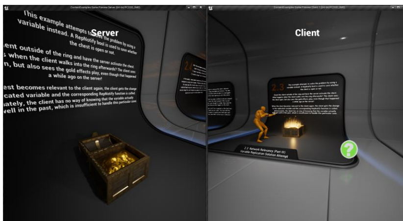
Kuva 22. Kuva "Networked features" -projektista, esimerkki missä yritetään korjata ongelma, jossa yhdistävä pelaajalle päivitetään olemassa oleva tieto kirstun avaamisesta.
