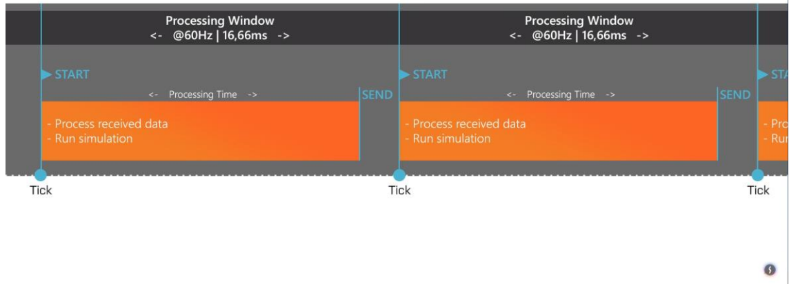
Kuva 5. Esimerkki simulaatioaskeleen vaiheesta, simulaatiopäivityksen aikana. Kuva otettu "Battlenonsense"-Youtube-kanavan videosta. (5.)
