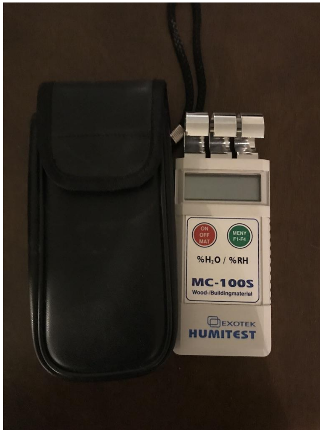
Kuva 14. Pintakosteusmittari jolla mitattiin CLT elementtien kosteuksia hukanhaudan päiväkodilla.
