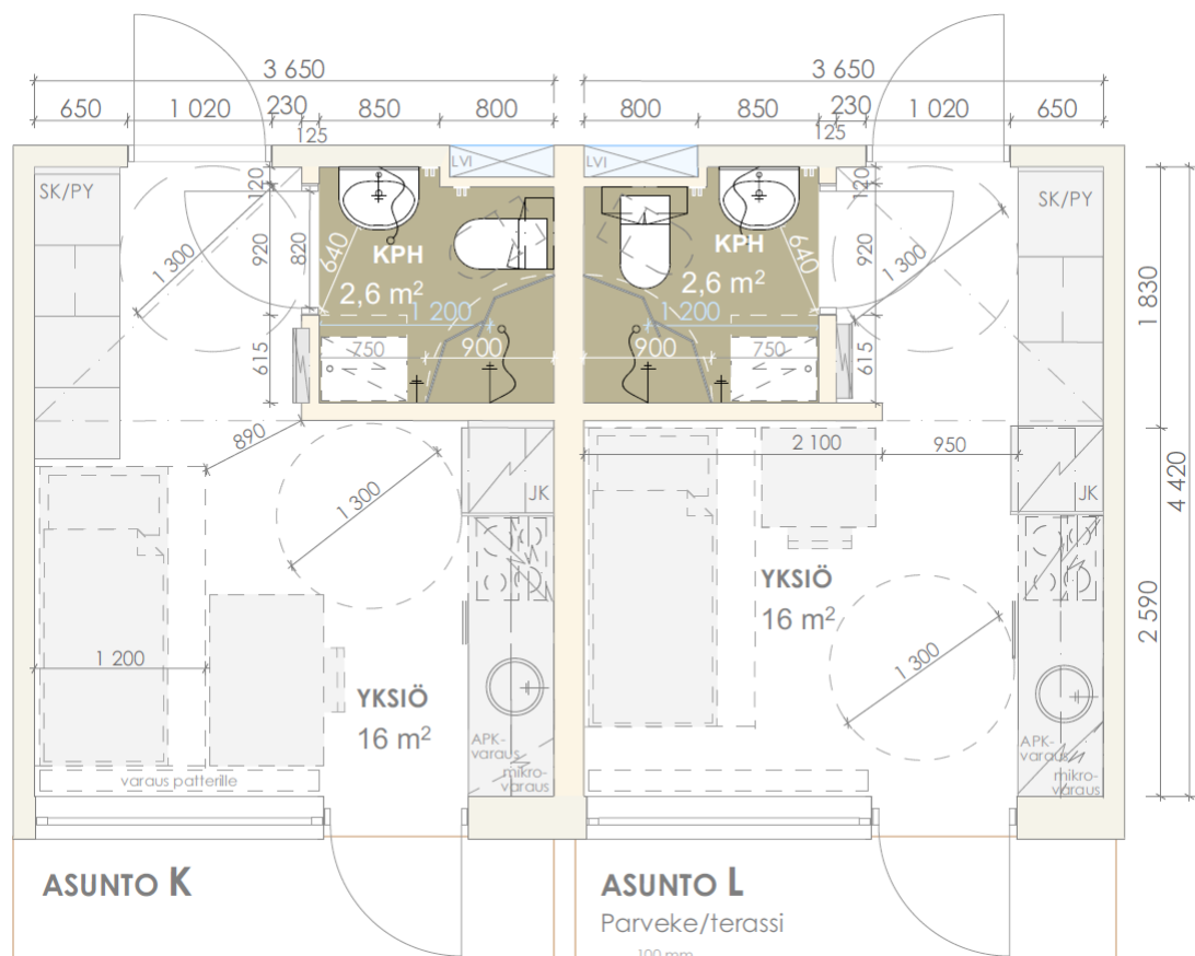
KUVA 24. Tehokkaimmillaan pyykinpesukonevarauksella oleva kylpyhuone on 2,6 neliömetriä. Suihkun ja pyykinpesukoneen väliin suositellaan suihkuseinää.
