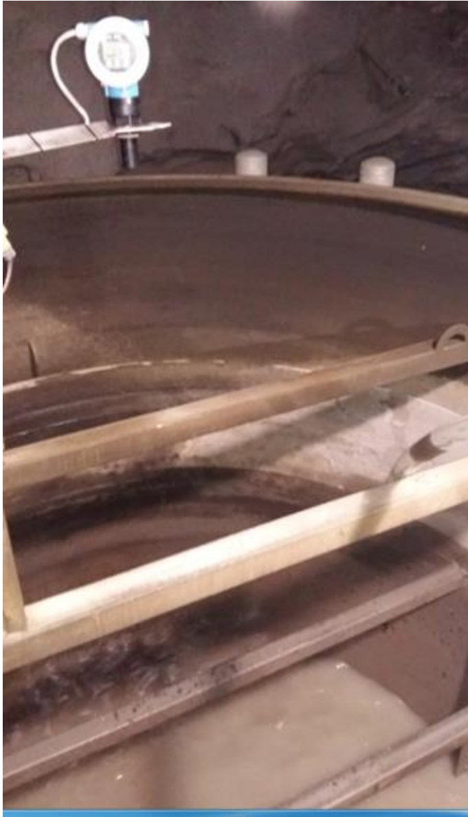
Kuva 12 Säiliömittaus Kemin kaivoksella.
