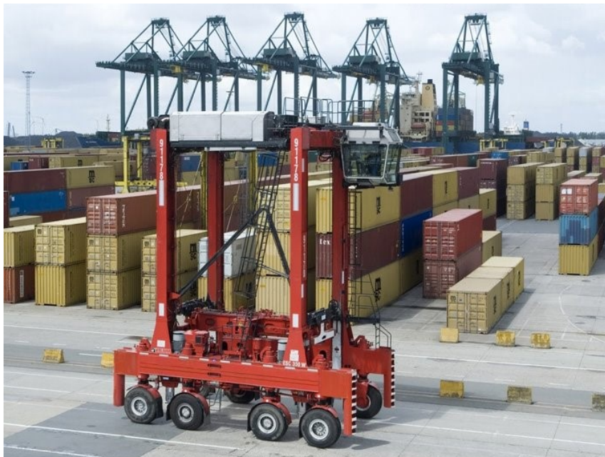
Kuva 4. Lukkitrukki (Kalmar Global 2018.)
