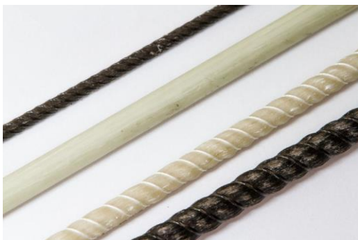
Kuva 15. FRP-tankoja. Keskimmäiset ovat lasikuitua ja reunimmaisiet ovat basalttia.
