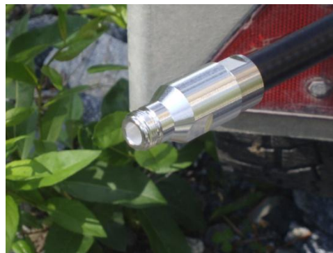
KUVA 7. LCF12-50 naarasliitin, joka on tehty ½”-50 RFA-kaapeliin. (Salmela 2009)
