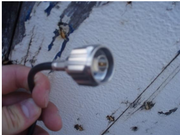
KUVA 9. RG58-koaksaalikaapeliin tehty N-liitin (Salmela 2009)
