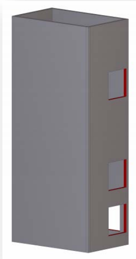
Kuva 2: Esimerkki mallitarkkuudesta yleissuunnitteluvaiheessa (Yleiset tietomallivaatimukset 2012. Osa 5. Rakennesuunnittelu. RT 10-11070, 11)
