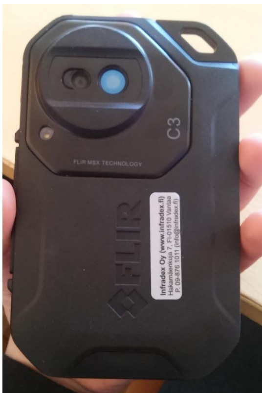
KUVA 2. Flir C3 -lämpökamera (Koskela 2018-04-11a.)
