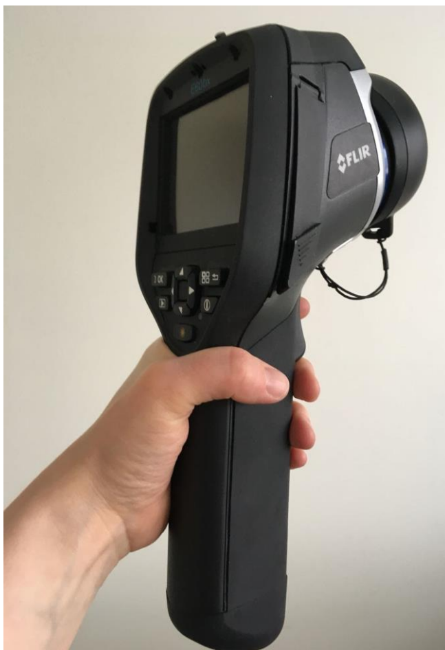
KUVA 1. Flir E60bx -lämpökamera (Ruuska 2018-03-03.)
