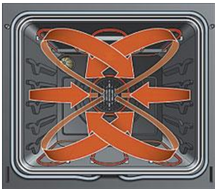
KUVA 4. Kiertoilmauunin toiminta ( T.Johnston 2014.)
