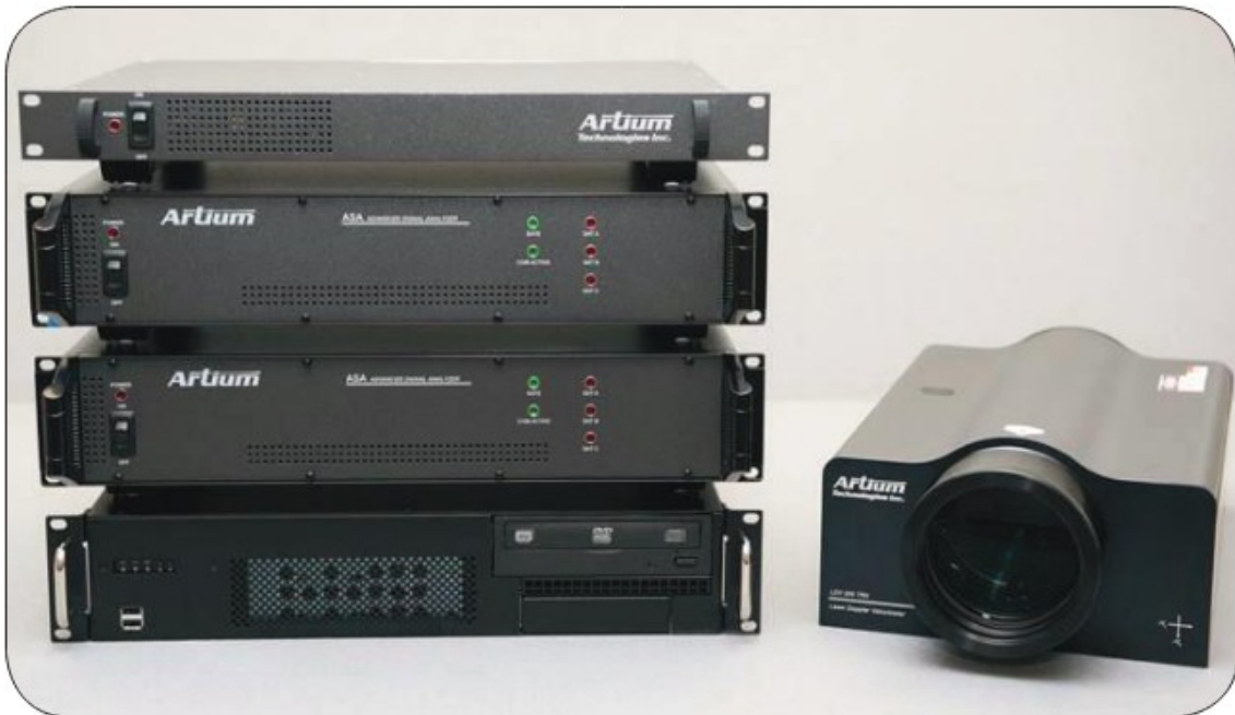
KUVA 8. LDV laitteisto (11, Lupa saatu Artium Technologies, Inc.)
