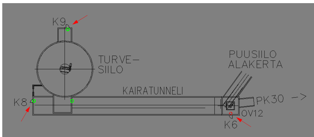
Kuva 14. Kairatunnelin CAD-kuva lisätyillä opastevalaisimilla (Raumaster 1999)
