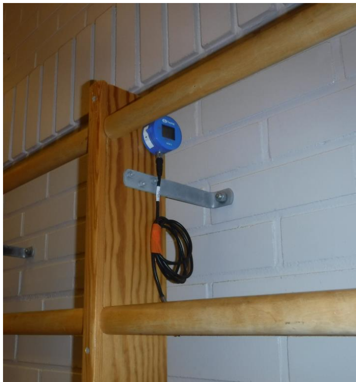
Kuva 6. Havainnekuva liikuntasalin sisäilman dataloggerimittauksesta.
