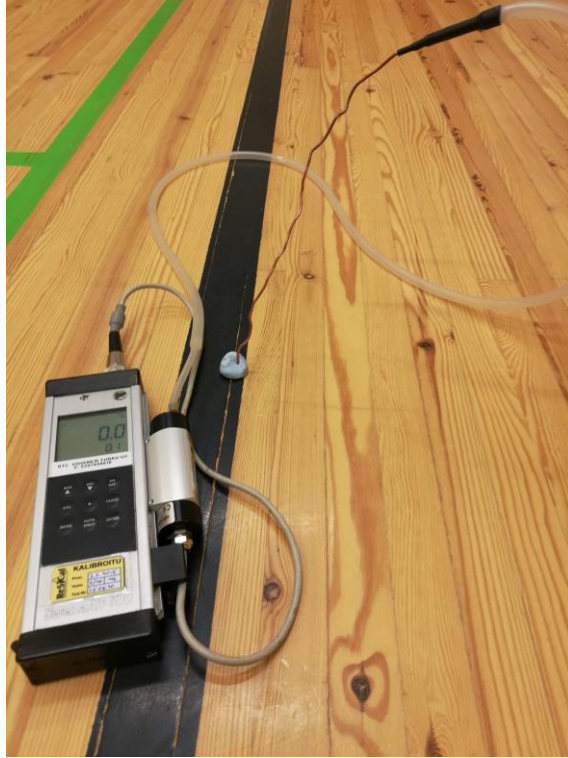
Kuva 7. Alapohjan eristetilän ja sisäilman välinen paine-eromittaus.
