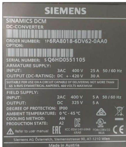
Kuva 13. SINAMICS DC-käytön nimikilpiedot.
