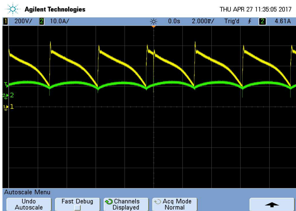
Kuva 44. Oskilloskooppikuva ajettaessa 3000rpm maksimi vastamomentilla virtarajalla.
