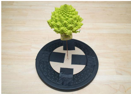
Kuva 9. Esimerkki telineestä, jossa taso ja kohde eivät kosketa (Holmes, Shooting for Photogrammetry, n.d.b)
