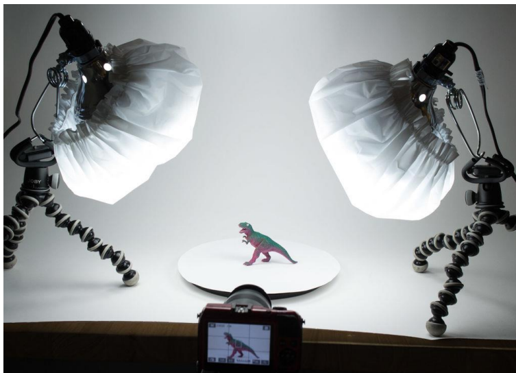
Kuva 8. Valkoinen kangas ja valaistus suunnattuna pyörivään pöytään (Holmes, Shooting for Photogrammetry, n.d.b)
