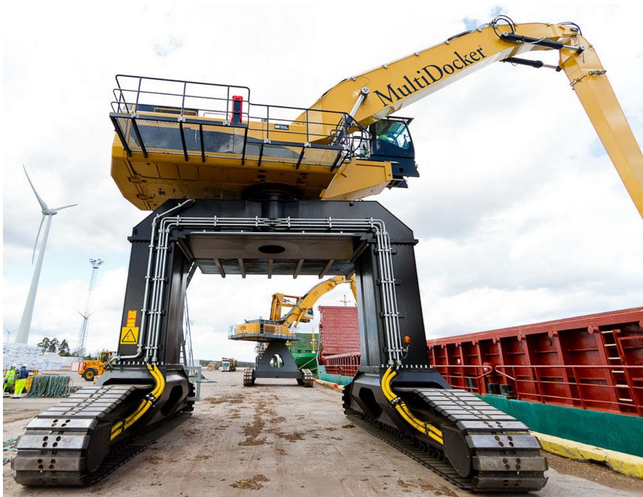
KUVA 1. Multidocker, jossa Hägglomin toimittama telaketjusovellus (Ab A. Hägglom Oy.)
