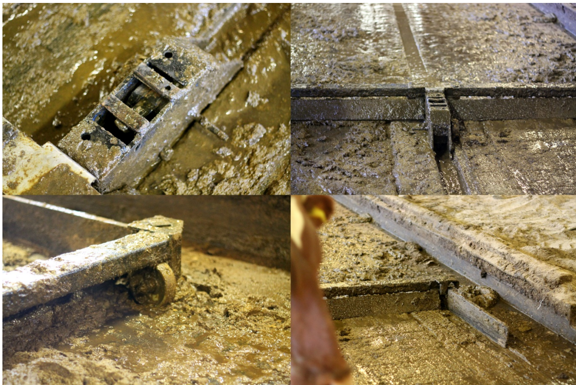
KUVA 12. Lantaraapat on asennettu kulkemaan pyörien päällä, jotta raapat eivät kuluisi niin paljoa (Tavaststjerna 2017-10-04).
