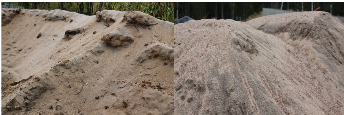
KUVA 3. Tilan oman hiekkakuopan hiekka (vasemmalla) ja ostohiekka (oikealla). Oma hiekka on hienojakoista, ostohiekka puolestaan karkeampaa (Tavaststjerna 2017-10-04).
