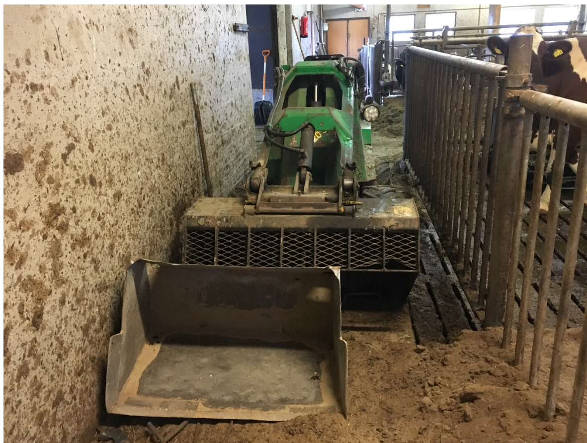
KUVA 7. Hiekka tuodaan parsiin pienkuormaajan kauhalla, puoli kauhaa partta kohti (Kuikka 2017-10-04).
