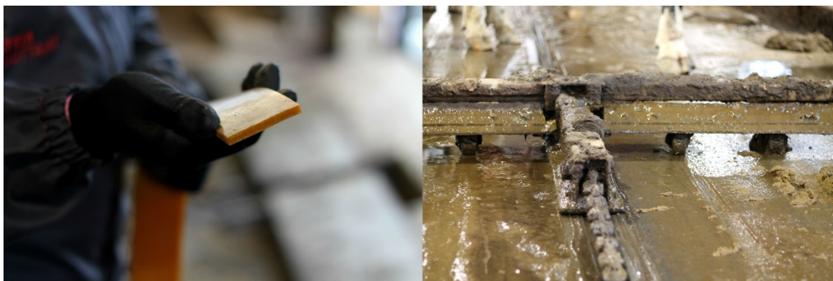
KUVA 22. Lantaraapoissa on kumit, jotka kestävät hyvin kulumista (vasemmalla). Myös raappojen ketjut ovat kestäneet hyvin hiekan kanssa (oikealla) (Tavaststjerna 2018-02-15.)
