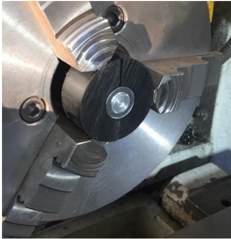
KUVA 7. Pienempi hihnapyörä kiinnitettynä sorviin muovisella sovitteella
